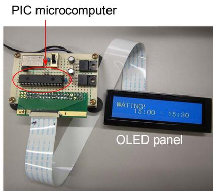
Fig. 3 The OLED display module.
